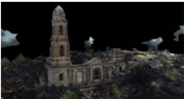
Figura 4. Reconstrucción de la ruina del templo de San Juan Parangaricutiro a partir de las imágenes obtenidas
