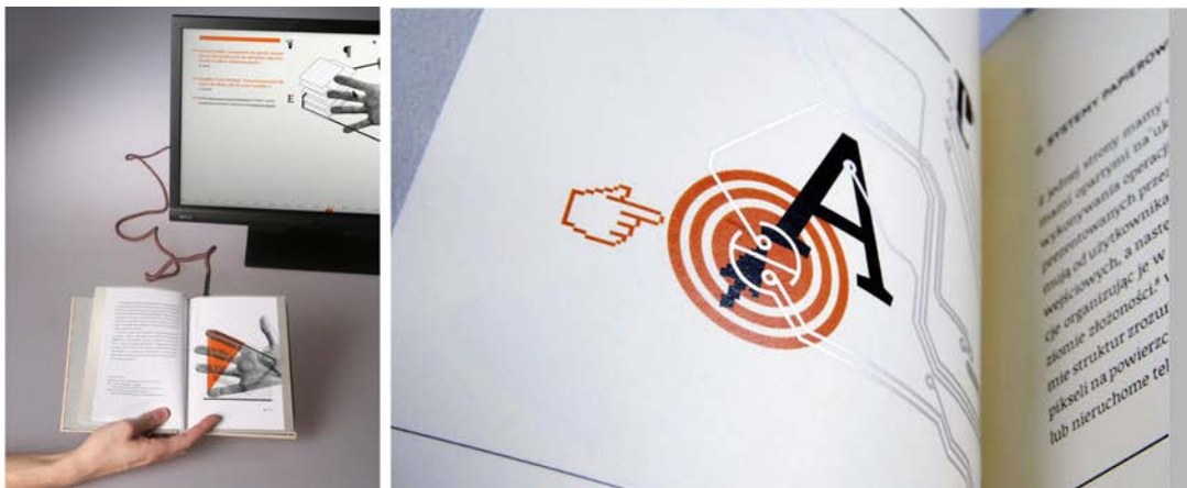
Figura 4. Electrobiblioteka . A la izquierda la interfaz física del libro que se usa para navegar una página web, a la derecha un detalle de la tinta conductiva. © Waldemar Węgrzyn
