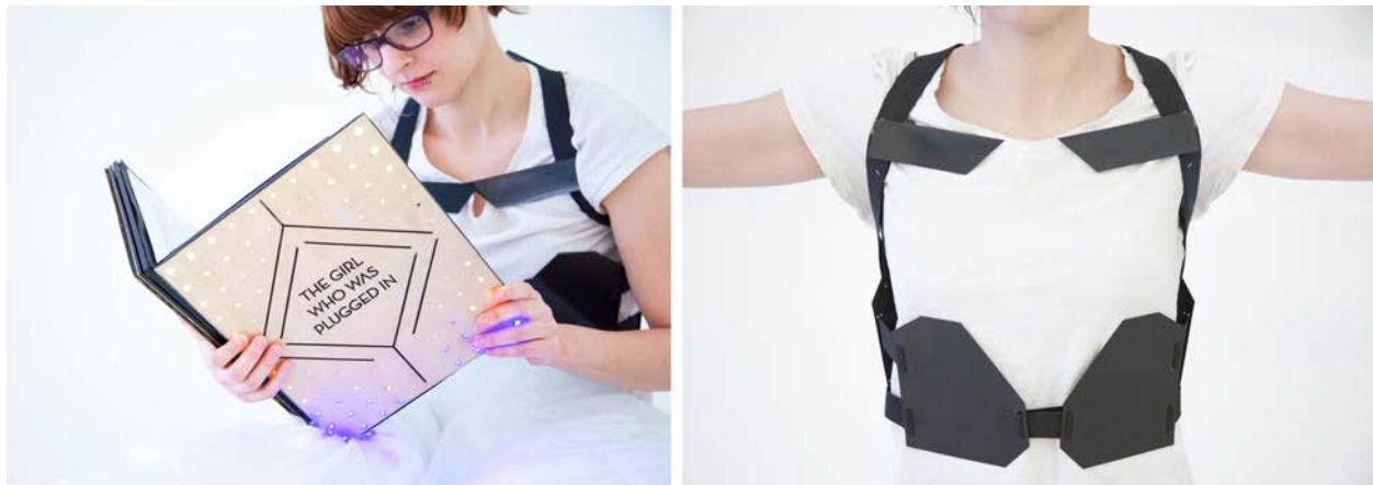
Figura 5. Sensory Fiction . La interfaz física del libro que está conecta a un chaleco que tiene actuadores que reaccionan de acuerdo a la narrativa. © MIT
